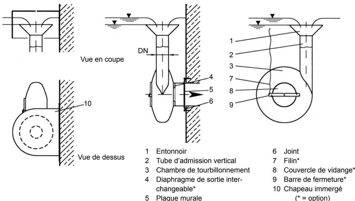
Fig. 1 : Constitution d'un régulateur vortex vertical UFT-*FluidPond*.
