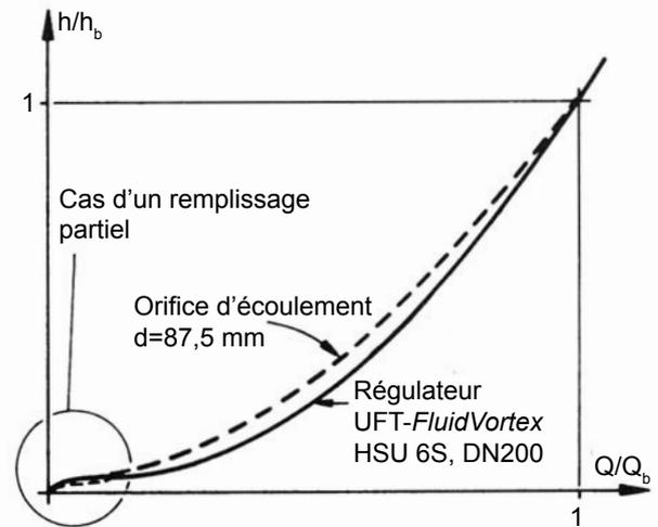
Fig. 3 : Comparaison de la courbe caractéristique hydraulique du régulateur UFT-FluidVortex et celle d'un orifice d'écoulement.  $h_b$  et  $Q_b$  sont respectivement la charge d'eau maxi et le débit de dimensionnement.
