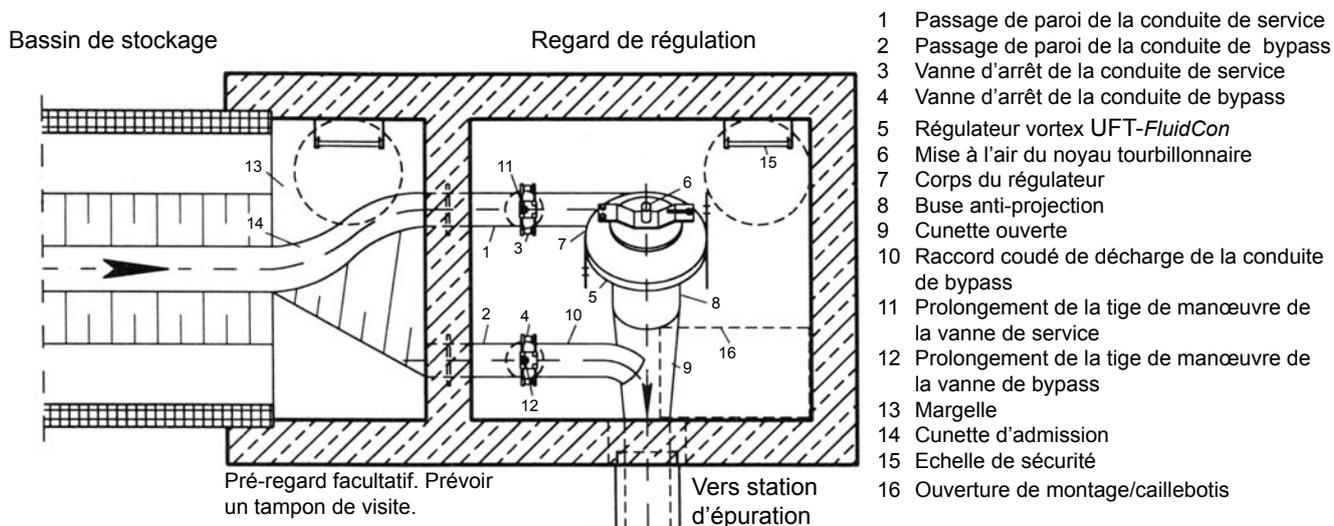
Fig. 4 : Vue de dessus d'une chambre de régulation avec un régulateur vortex conique UFT-FluidCon en installation sèche.
